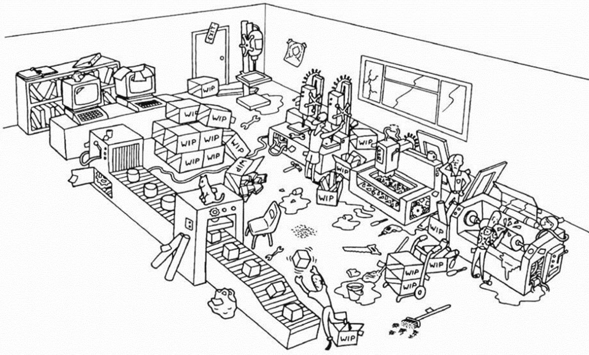
Figuur 1: een ongeordende werkplek, waar 5-S nog niet is toegepast
